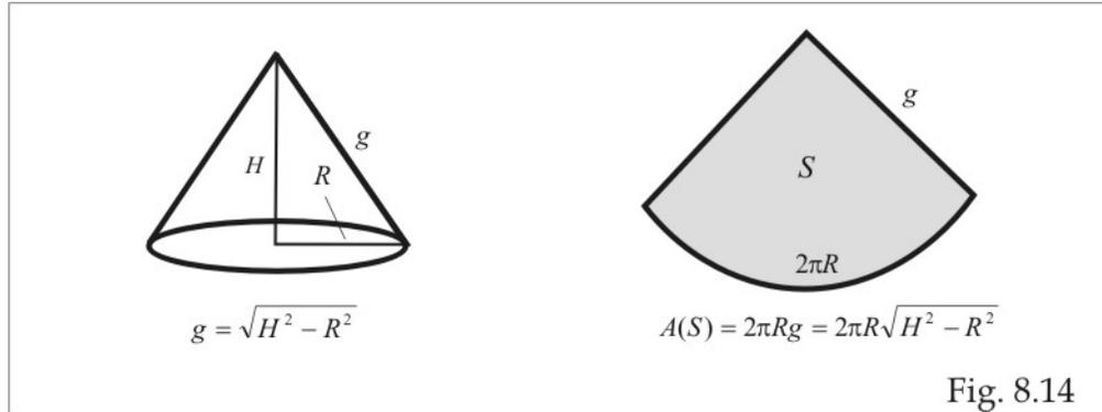
Em uma situação geral, supõe-se que  $S$  seja obtida por rotação em torno do eixo  $x$ , do gráfico de uma *função suave*  $y = f(x)$ ,  $a \leq x \leq b$ . Por *função suave* entende-se um função  $f$  que é contínua e tem primeira derivada contínua no intervalo  $[a, b]$ . A área infinitesimal  $dS$  é aproximada pela área do cilindro de raio  $f(x)$  e altura  $ds$ , sendo  $ds$  o comprimento do arco sobre o gráfico de  $f$ , como sugere a Figura 8.15.
