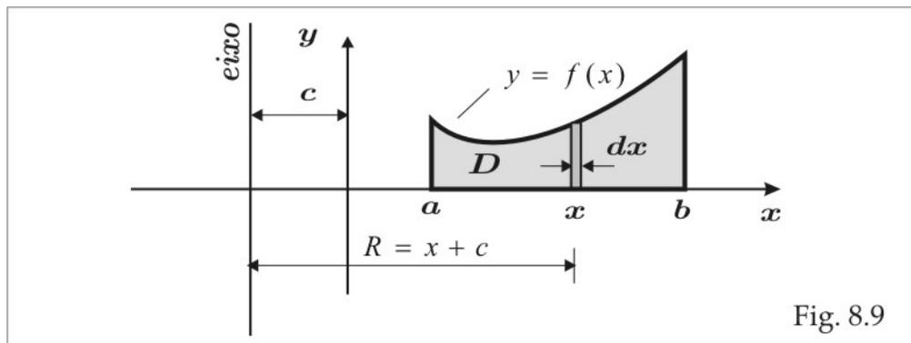
Se a rotação ocorresse em torno do eixo  $y$ , então o volume seria:  $\text{vol}(\Omega) = \int_a^b 2\pi x f(x) dx$
