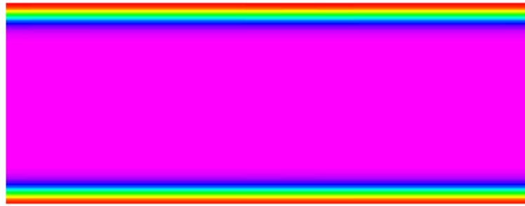
Figura 40: Campo de pressão com Re = 500.0
