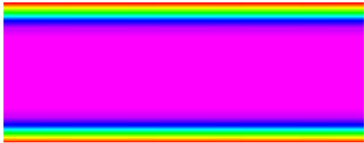
Figura 38: Campo de pressão com Re = 250.0
